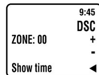
8. Über die Funktionstaste ◀ wird das Einblenden oder Ausblenden der Zeit im Display aktiviert.
