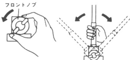
アンテナの長さに合わせて、好みの強度にフロントノブをセットでき、車庫入れのときなどカンタンに倒せて便利です。
