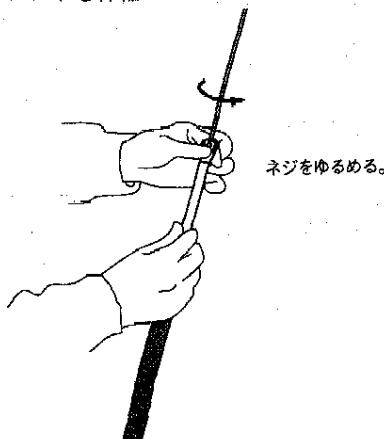
②ファイバーエレメントを金具の中に入れる長さにより周波数が変化します。エレメントを伸ばすと共振周波数が下がり、逆に縮めると共振周波数は上がります。通常の使用状態では、ファイバーエレメントを中間（最短から約5cm伸ばす）にしたときに、アマチュアバンドの中心付近がSWR最良点となるように設定しています。
