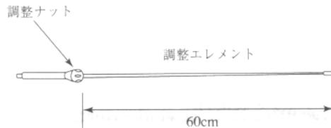
※出荷時は上記寸法に合わせてあります。調整後は、調整ナットをしっかりと締め付けてください。
