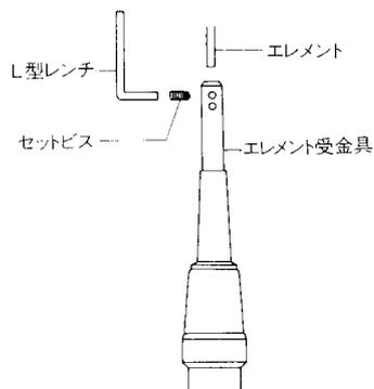
位相コイルがゆるんだりした場合は、上下のエレメントを取りはずし、図のようにL型レンチを位相コイル内へ入れて締め付けます。
