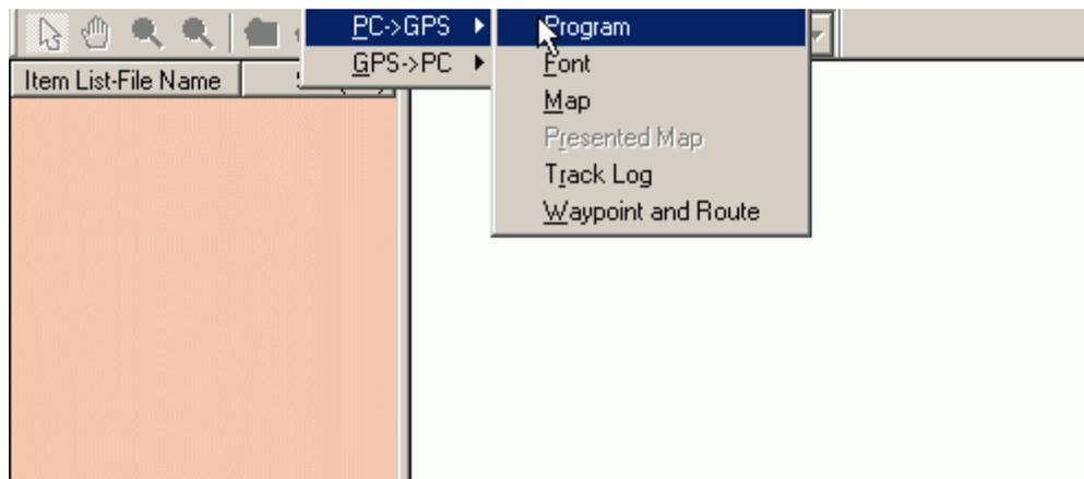
Sie werden aufgefordert, die Programmdatei (z.B. **v102za-m.bin**) von der Festplatte auszusuchen. Nach der Bestätigung mit OK beginnt beim Map 500 nun zunächst das Löschen des alten Betriebssystems (Flash-Memory), danach das Laden des neuen Programms. Sobald das Update des Betriebssystems abgeschlossen ist, schaltet sich Ihr MAP 500 automatisch aus.
