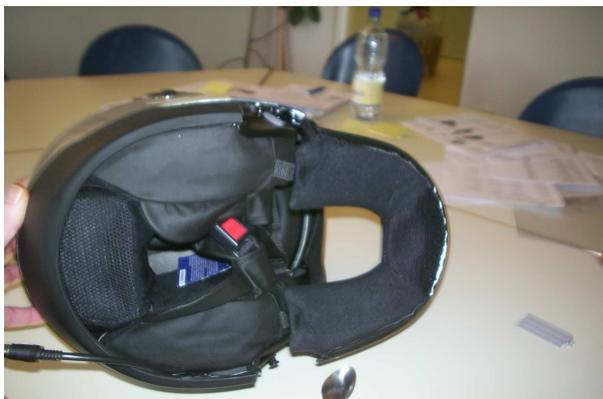
Demontieren Sie zunächst den Windschutz (Kragen) vollständig von Ihrem Helm. Überlegen Sie sich nun, an welcher Seite das Ende des Anschlußkabels (Stecker) aus den Helm geführt werden soll.
