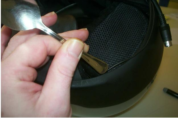
Im weiteren Verlauf lassen Sie jetzt das Kabel zwischen Polsterung und Helmpanzer mit Hilfe des Löffelgriffs einfach verschwinden.
