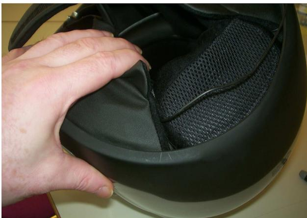
Verlegen Sie das Kabel, wie im Bild gezeigt, einfach zwischen den Polstern.
