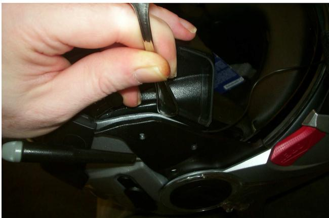
In dem sich nun geöffneten Spalt können Sie das Mikrofonkabel sauber verlegen (siehe Foto). Achten Sie darauf, dass Sie beim hineindrücken mit dem Löffelstiel weder das Kabel des Mikrofons noch Ihren Helm beschädigen. Drücken Sie das Kabel nicht zu tief in den Spalt, da es sonst beim Festschrauben der Blende von den Schrauben beschädigt werden kann.
