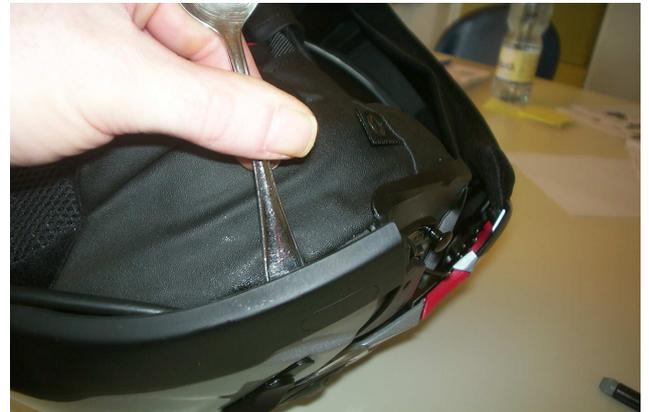
Mit dem Hauptkabel wird hier ähnlich verfahren, wie zuvor bei der Verlegung der Hörekabel.
