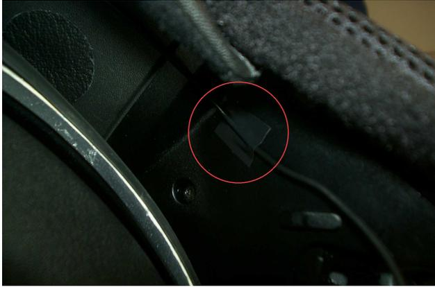
Das Mikrophonkabel können Sie auch noch an geeigneter Stelle mit einem gut haftendem Klebeband fixieren. Achten Sie auch hierbei auf ausreichende Länge des Kabels.
