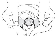
Befestigen Sie nun das **BT SKI** auf dem Klebeband. Setzen Sie das Headset auf, stecken Sie das Anschlusskabel vom Headset in das BTSKI Modul und setzen Sie dann den Helm auf.
