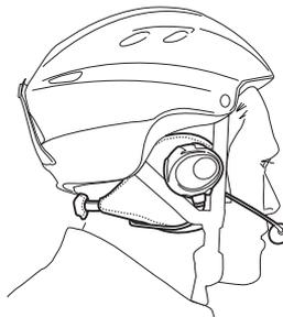
Hat Ihr Schutzhelm nicht die beiden herausnehmbaren Polster, so setzen Sie Ihr **BT SKI**-System mit dem mitgelieferten Klettband ein. Bitte befestigen Sie das Klettband, wie in der Abbildung dargestellt.
