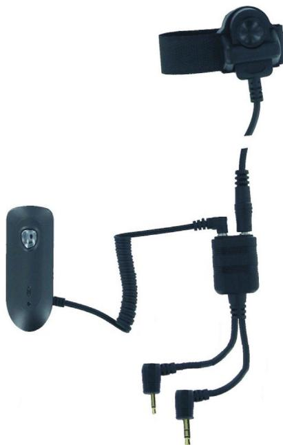
Il **BPA 100 G** è un adattatore Bluetooth® che permette l'utilizzo di un auricolare wireless, compatibile con lo standard Bluetooth, con i ricevitori ALAN o MIDLAND con connettore microfono/auricolare a 2 pin. L'adattatore può anche essere collegato a navigatori o ad altri dispositivi audio con presa jack 2,5mm stereo.
