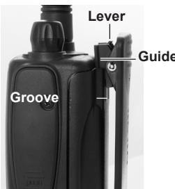
Για να επαναποθετήσετε το κλίπ σύρετε το πάνω στο αυλάκι που βρίσκεται στην μπαταρία της συσκευής μέχρι να ακούσετε το χαρακτηριστικό κλίκ.
