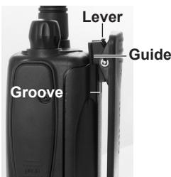
Para volver a colocarlo, insértelo en las guías que a tal efecto tiene la batería en su parte trasera y deslícelo hacia abajo hasta que quede fijo en su lugar.
